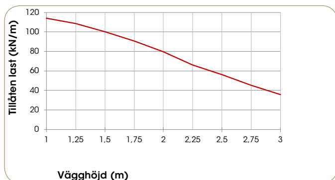
Diagram D: Tillåten centrerad vertikal last.
